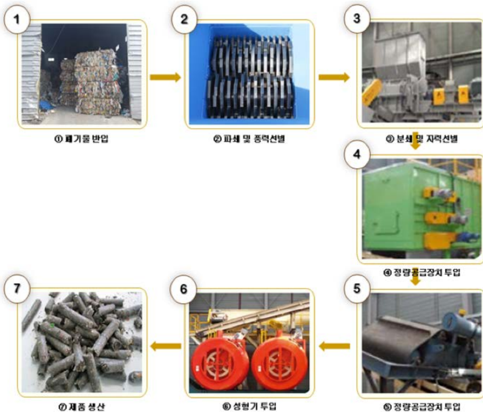
< 그림 30 > 고형연료 (Solid Refuse Fuel) 생산 공정
